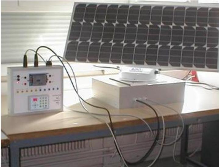
La partie opérative comprend le panneau solaire proprement dit, les batteries et la motorisation ; l'ensemble étant monté sur un socle en profilé d'aluminium. Le socle intègre deux batteries de 12V/7Ah et un chargeur de batterie.
