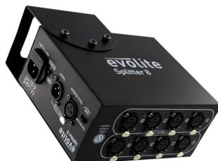
Un splitter DMX peut également protéger votre console au cas où vous y connecteriez un projecteur défectueux ! Un éclairage LED entrée de gamme peut présenter quelques dysfonctionnement en interne, et envoyer du voltage sur la ligne DMX et aurait pour incidence d'endommager sérieusement la puce DMX de votre console. Pour éviter ce genre de désagrément, nous vous conseillons bien entendu de toujours avoir un splitter DMX branché sur la console d'éclairage.
