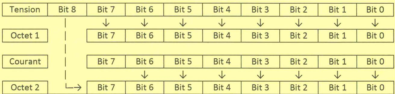
Exemple : pour une PDDG ayant une tension de charge de 29,6 V et un courant de charge de 1,5 A
