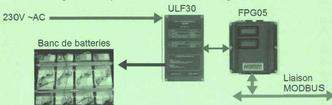
L'équipement de contrôle FPG05 indique en temps réel à l'équipe de remisage la valeur de la tension batterie et celle du courant de charge. Elle peut ainsi décider, à la lecture de ces valeurs, de déconnecter le banc de batteries en cours d'entretien pour l'affecter à un autre banc. Le FPG05 est équipé d'une liaison MODBUS. Ce dernier, programmé en esclave, transmet les trois données mesurées sur requête, par cette liaison.
