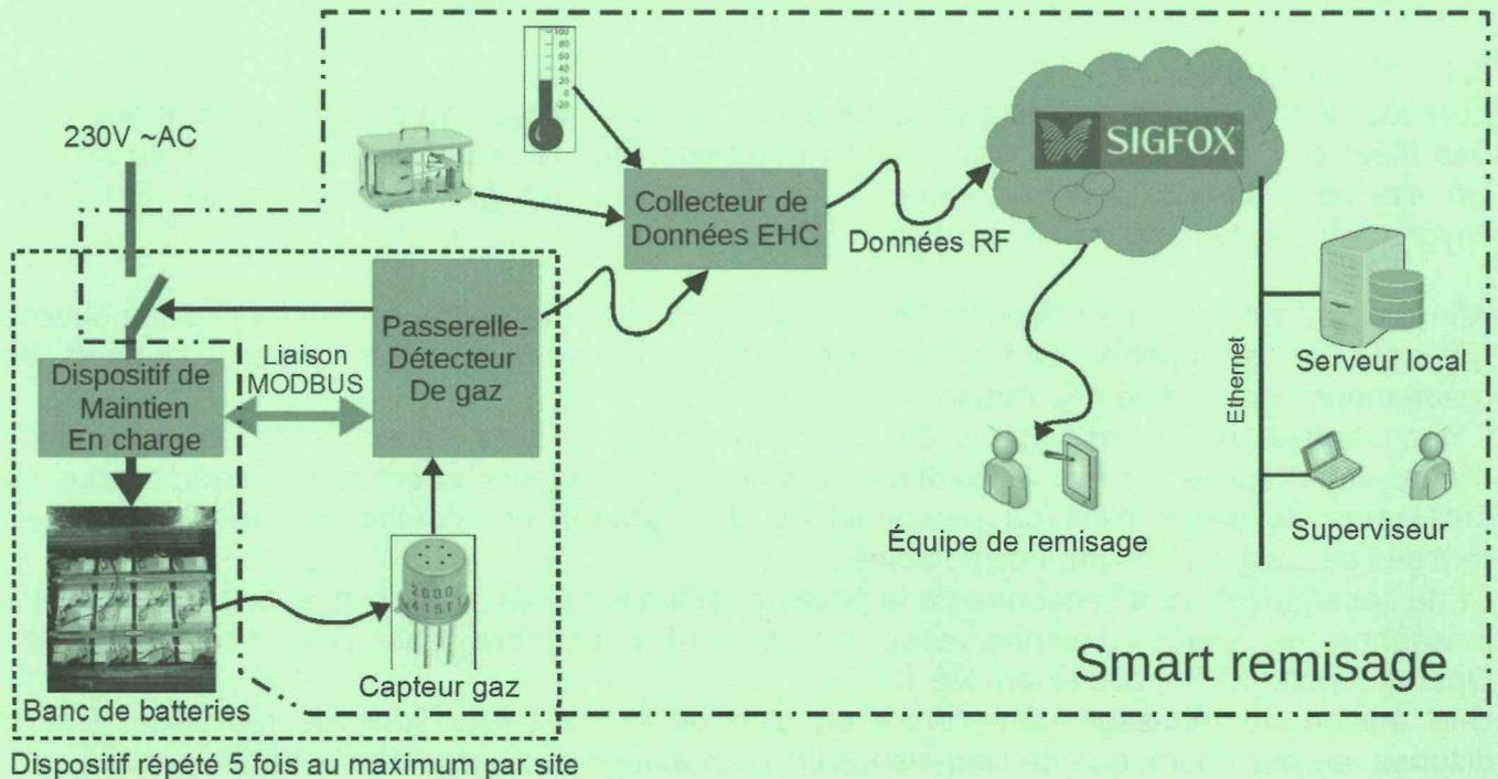
Le système est constitué principalement de la « Passerelle-Détecteur de gaz » (5 au maximum) et d'un « Collecteur de Données EHC ».
