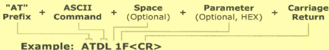
To read a parameter value stored in the RF module's register, omit the parameter field.
