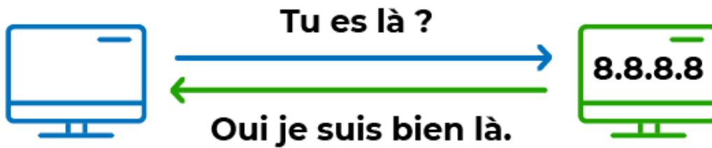
Principe de fonctionnement du ping
