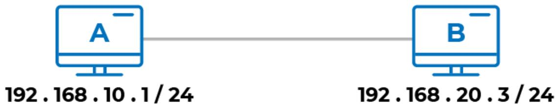
Configuration IP sur un réseau point-à-point
